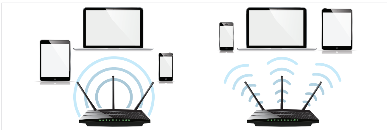
図 3. 1 つの空間ストリーム (左) と 3 つの空間ストリーム (右) によるビームフォーミングの例 3 。
