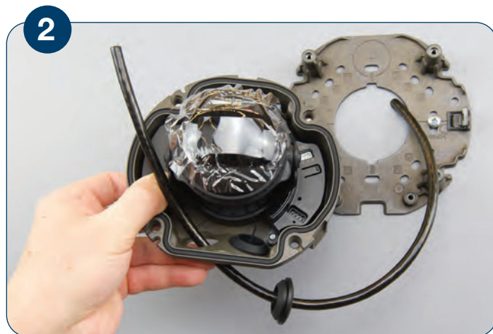
ケーブルの端をカメラの開口部に通します。
