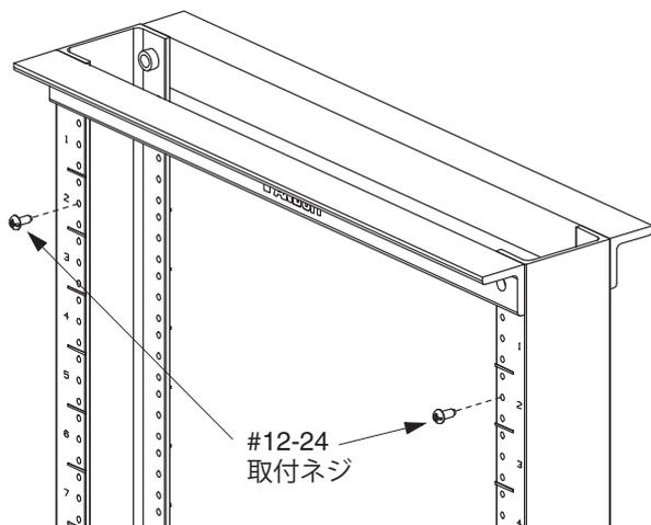
パネルの背面にネジと取り付ける
