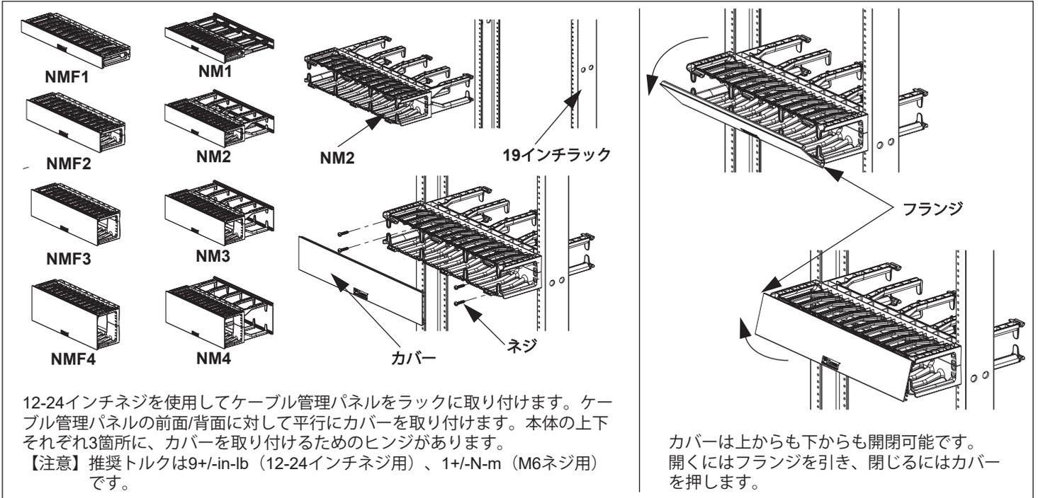
ケーブル管理パネルは、24ポートあるいは48ポートのパッチパネルとの使用に最適です。パッチパネルにケーブルを取り付ける際は下記の手順のいずれかを行うことで、ケーブルの曲げ半径を最適に保つことができます。
