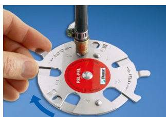
② ディスクを回転させてカブラにしっかり固定する
