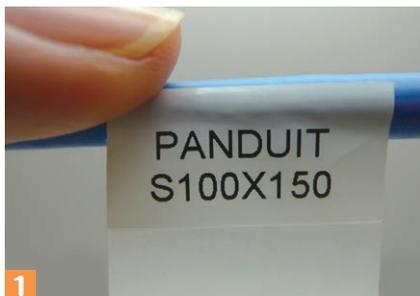
ラベルの白い部分（印字部）をケーブルに水平に貼り付けます。
