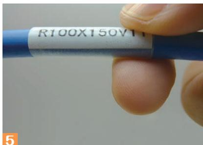
ラベルは、回転、スライドさせる事が可能です。ラベル取り付け後、アンカー部を取り外してください。
