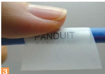
透明のラミネート部分を印字部の上に被せて貼り付けます。
