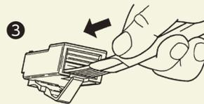
③ モジュラープラグ内部のガイドに合わせて導線を奥まで挿入する。
