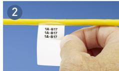
2 ラベル最上部の粘着部(アンカー)をケーブルに貼り付ける。その際、ケーブルに対してまっすぐにラベルを取り付ける。
