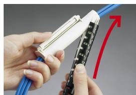
③パンラップを工具に取り付け、先端が束線を8cmほどカバーするまで差し込む。
