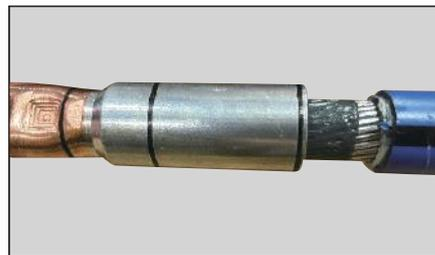
次に、直線接続（アルミ側）にアルミ電線を挿入。
