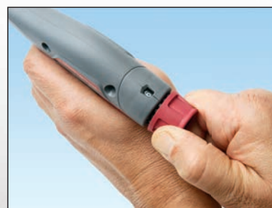
工具の推奨設定は HVY 4-6 通常の H 幅の結束バンドよりも低い締付強度設定で、しっかりと束線を保持します。
